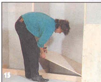
Дно вставляют и свинчивают шурупами с цоколем.
