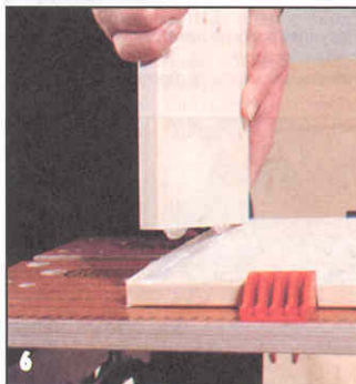
Выдвижные ящики склеивают на шпонках, которые вставляют в заранее выбранные фрезой пазы.
