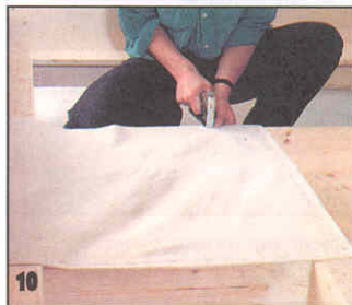
Чтобы в ящики не попадала пыль, над ними на каркасе кровати натягивают миткаль и прибивают его скобками с помощью степлера.
