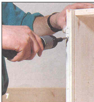
Направляющие для выдвижных ящиков крепят к каркасу кровати, а держатели роликов — к самим ящикам.
